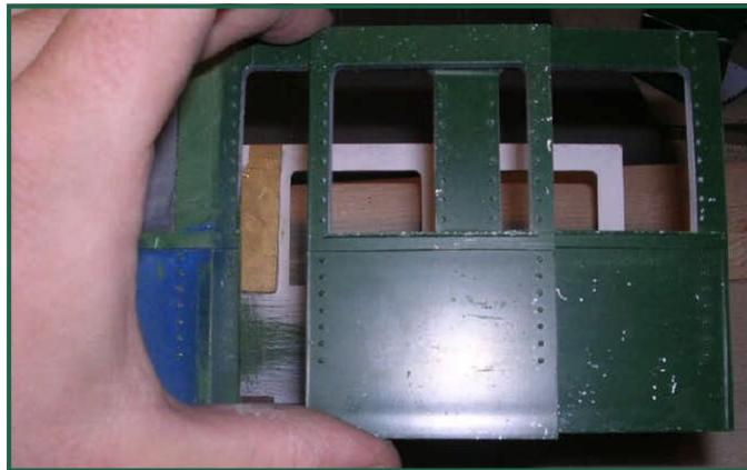
So sieht der fertig bearbeitete Wagenkasten aus, an den nun mit etwas Geschick die beiden dünnen Streifen für die Rückwand ange-setzt werden müssen.
