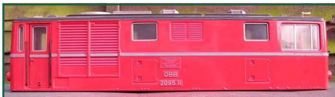
Wird zerlegt - also die Fenster, alle Zurüstteile entfernt und die Farbe abgebeizt:
