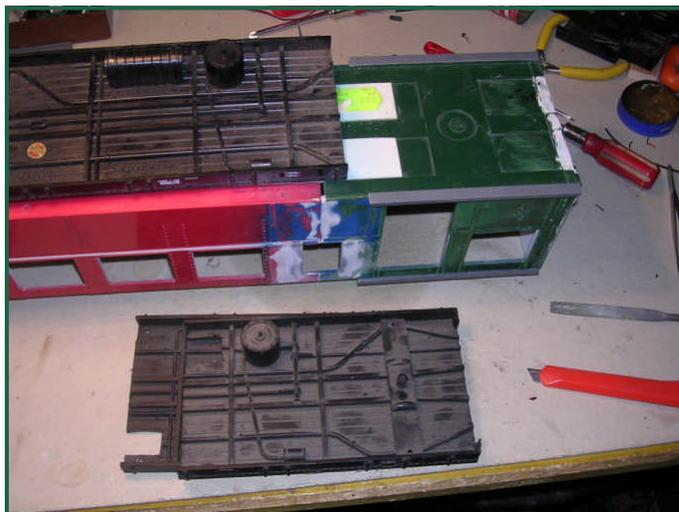
Zwischen der Pufferbohle und dem originalen Rahmen war es durch die Verlängerung notwendig, noch ein paar kleinere Stücke einzusetzen. Dabei ist besonders darauf zu achten, dass die Aufnahme für das Drehgestell exakt so platziert wird, dass der Kupplungsbügel optisch wieder korrekt mit der Vorderkante des Puffers endet.
