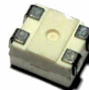
PLCC Bauform mit 4 Anschlüssen. Die beiden LEDs sind voneinander isoliert. Daher kann man alle denkbaren Beschaltungsvarianten vorsehen. Die Problematik der Stromumkehr die oft bei 2 FarbLEDs gibt es hier nicht.
