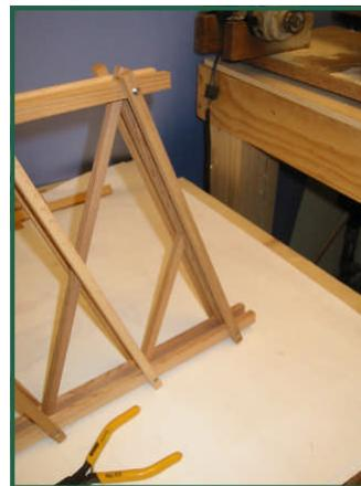
werden die Verbindungen unten befestigt. Diese werden mit den langen Gewindestangen montiert. Das ist sehr zeitaufwändig, man muss unten die Kontermutter mit Beilagscheibe
