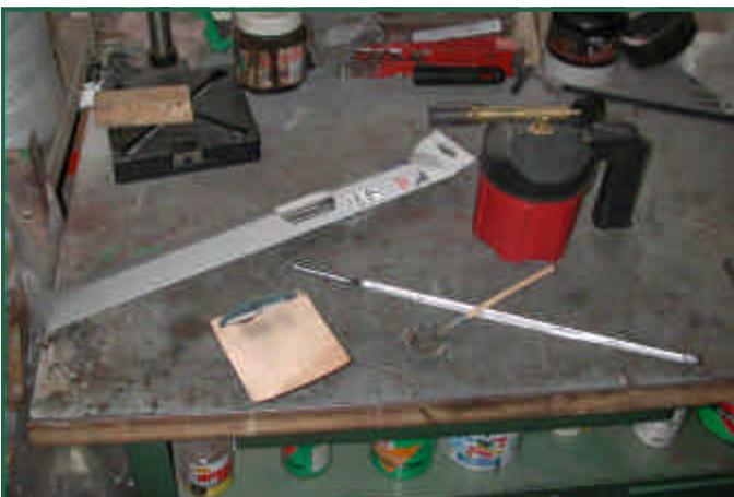
Zuerst habe ich die Form zwischen zwei nasse Sperrholzbrettchen geklemmt. Dann wurde eine Stange Zinn in handliche Happen zersägt und diese auf dem Silvesterbleigießlöffel mit der Lötlampe geschmolzen.
