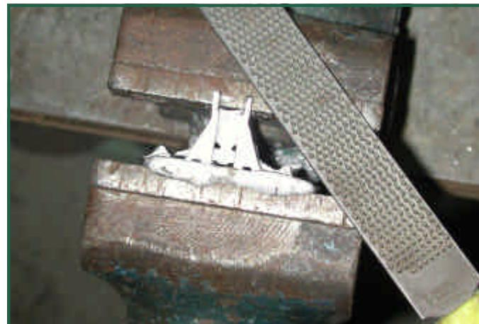
bearbeitende Werkzeuge (Feile, Schleifscheibe etc.) in kürzester Zeit "zu" sind, kann man meiner Meinung nach nur halbwegs sinnvoll mit einer groben Raspel das Material bearbeiten. Für die Durchbrüche und andere Kleinigkeiten verwende ich eine Minibohrmaschine mit einem Holzfräser ...
