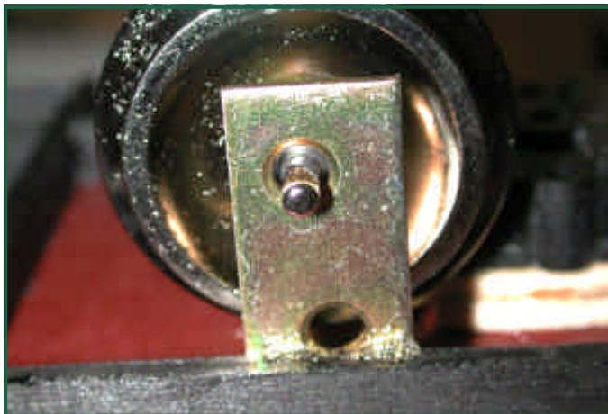
Für die Achsblenden habe ich zuerst einen Abdruck der Blende von einem LGB 2-achser in Glasererkit gemacht und diese Form dann mit StabilitExpress ausgegossen. Erstaunlicherweise funktioniert diese Methode durch-
