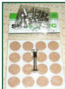
Die Schraube wird gekürzt und das Korkplättchen aufgeklebt. Fertig ist der Drehsessel.
