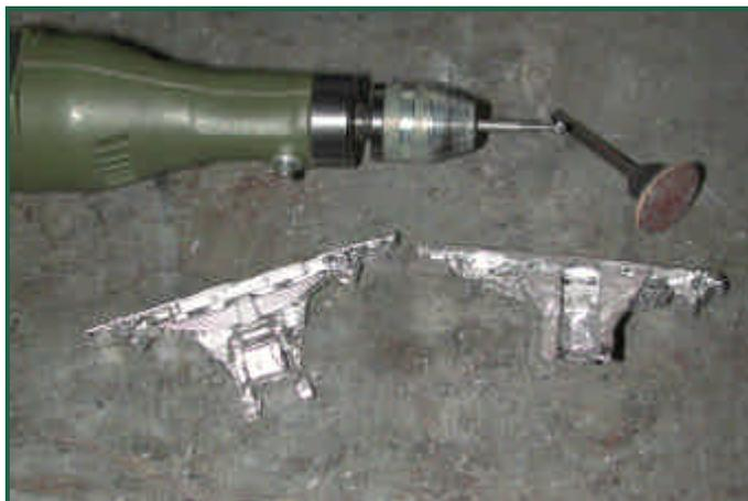
Nachdem alle Fehler mit Lötzinn und LötKolben sehr vorsichtig beseitigt und mit Fräser und Feile der Gussteil geputzt wurde, steht
