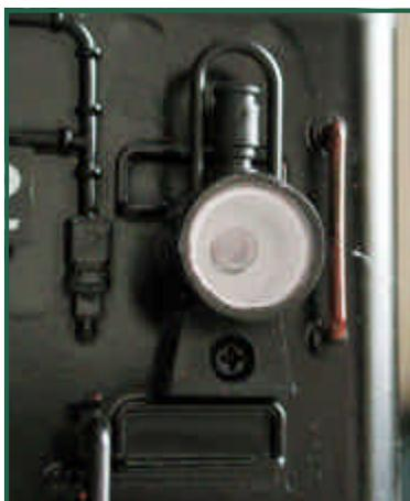
Die geriffelte Innenseite der Loklaternen-Gläser habe ich mit 800er Nassschleifpapier abgeschliffen und mit Autopolitur und einer Polierscheibe für die Minibohrmaschine poliert. Jetzt kann man die Lampe besser sehen. Der goldene Ring
