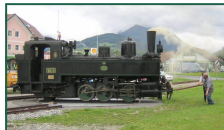
Die Bh1 wird auf der Drehscheibe gewendet.
