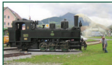
Die Bh1 wird auf der Drehscheibe gewendet.
