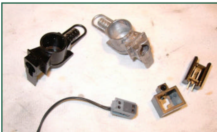
Oben - li. Laterne (Kunststoff) re. nachgegossene Laterne (Zinn) Unten - li. Stecker, Mitte Halter, re. Steckereinsatz
