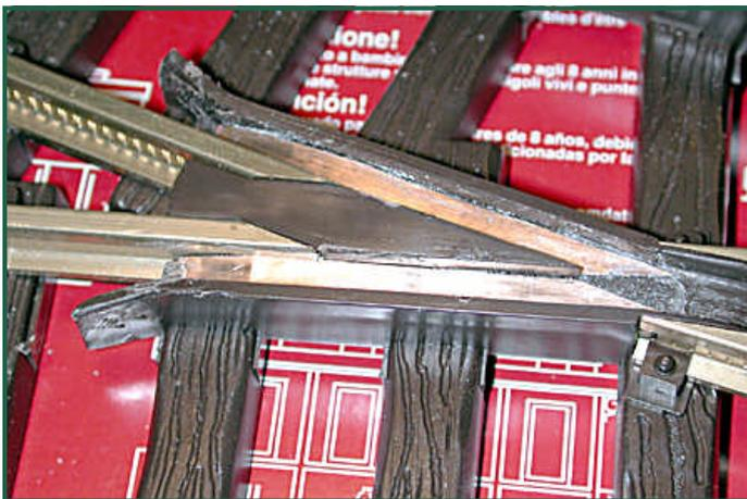
Also entschloss ich mich, eine andere Variante auszuprobieren - ich fertigte ein polarisiertes Herzstück. Dazu schnitt ich aus dünnem Messingblech einen Keil aus und lötete auf die Unterseite ein Kabel an.
