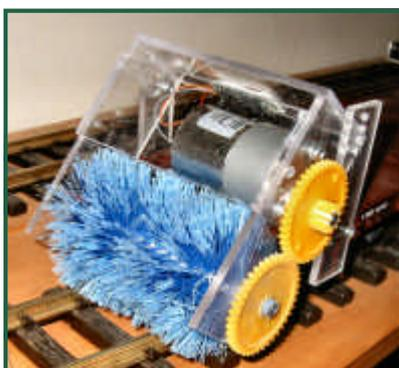
Kraftübertragung herzustellen. Weiters war das nötig, damit sich die Bürste nicht aufdreht. Die 2 Drähte, aus denen die Bürste aufgebaut ist, laufen durch 2 Kugellager, die im Acrylglas eingelassen sind.
