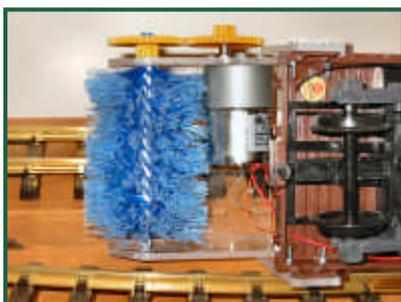
Die Kehrvorrichtung selbst besteht aus einem Plexiglas-Rahmen. Das Material ist leicht mit einer Kreissäge zu bearbeiten, bietet aber auch genügend Stabilität. Die Verklebung erfolgte mit Superkleber, weil er transparent
