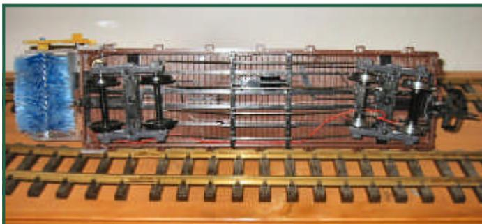
Die Bürste liegt nur mit geringem Gewicht auf den Gleisen auf. Die Querplatte beim Motor war gedacht, um zusätzliches Ballastgewicht zum Niederdrücken der Maschine aufzunehmen. Versuche in der Werkstatt mit allerlei "Schmutz" wie feuchtes Papier, kleine Schrauben, Styropor zeigten, dass das Gewicht der Konstruktion ausreichenden Anpressdruck erzeugt.
