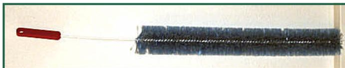
marktes. Ursprünglich war sie zur Reinigung von Heizkörpern gedacht. Sie hat etwa 5cm Durchmesser und besteht im Kern aus 2 verdrehten Drähten. Beim Absägen muss man aufpassen, dass sich diese Drähte nicht aufdrehen und man die Bürstenhaare verliert. Ich habe die Enden mit Superkleber fixiert.
