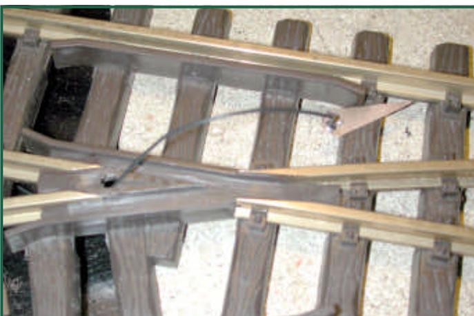
Dann bohrte ich ein Loch in das Kunststoffherzstück und führte das Kabel hindurch.
