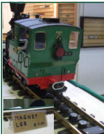
LGB bietet als Zahnstangen-ersatz starke Magnete an. Diese sollen die Lok so stark an das Gleis heften und somit die Reibung soweit erhöhen, dass die Lok auch steilste Bergstrecken bewältigen kann. Davon abgesehen, dass die Lösung optisch unvorteilhaft aussieht, ist der Stückpreis pro Magnet mit € 1,80 auch stolz ...
