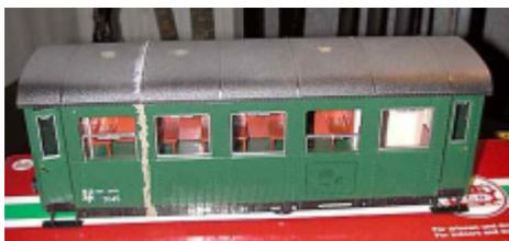
Die Trennfuge mit Spachtelmasse (ich verwendet Einkomponentenspachtelmasse von DupliColor in der Tube) ausfüllen und wenn dieser komplett ausgehärtet ist (nach ca. einem Tag) plan schleifen und die Trennstelle mit Lack ausbessern, oder den Wagenkasten und das Dach neu lackieren - je nachdem wie sauber man gearbeitet hat und ob man die ausgebesserte "Naht" stark sieht.
