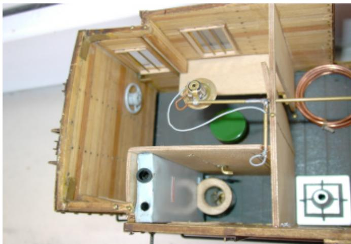
Innen, das Handbremsrad; an der Frontseite, nach zurückgesetzten Einstiegsstüren, die Halter für die Oberwagenlaternen. Laufbretter sind mit kleinen Messingnägeln und Flachwinkeln befestigt.
